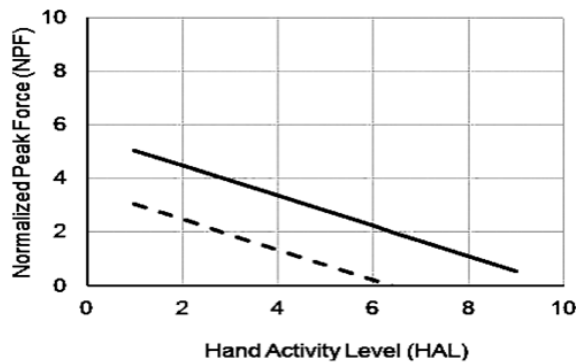
شکل ۲: حدود مجاز فعالیت دست برای کاهش اختلالات اسکلتی-عضلانی مرتبط با کار بر اساس فعالیت دست، سطح فعالیت دست (HAL) و حداکثر نیروی دست نرمال شده قرار دارد. خط ممتد بالا حدود مجاز را نشان می‌دهد. خط چین پایین، حد عمل (AL) است که در آن کنترل‌های کلی توصیه می‌شود.
